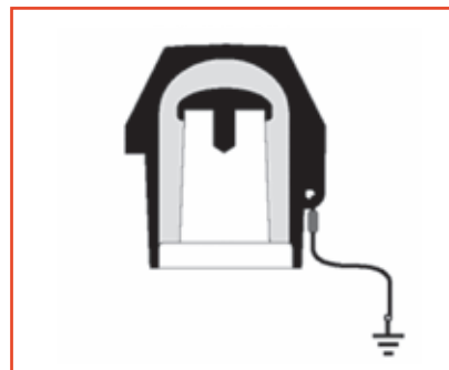
ZATYCZKA IZOLACYJNA PRZEPUSTU (K)150DR(/G) 250 A – do 24 kV
